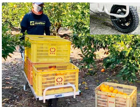
▲写真1 狭い園地でも移動は容易 (右上)モーターを内蔵した車輪
