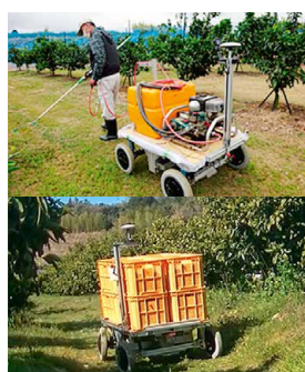
写真3 作業者に自動追従したり自律走行で運搬するロボット
