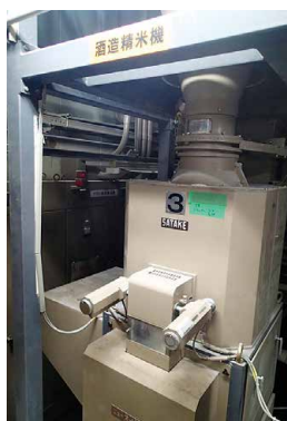
▲酒米専用の精米機（パールライス袋井工場）
