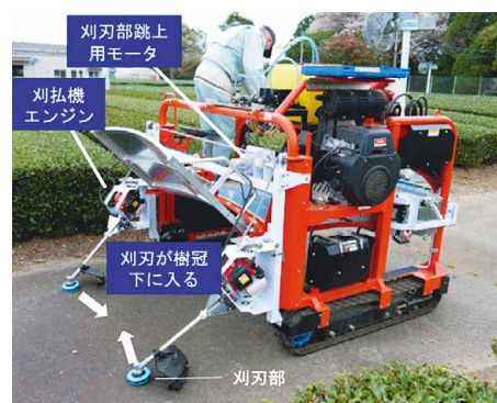
図4 茶園用病害虫クリーナー搭載型除草機（2022年10月特許出願）
