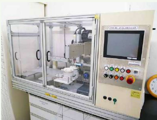
▲土壌診断：pH/EC自動測定装置
