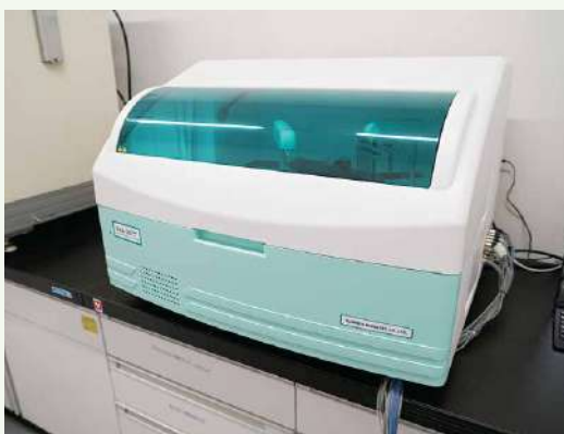
▲土壌診断：高速土壌養分自動分析装置
