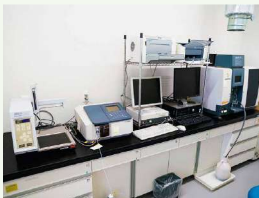
▲肥料分析：分光光度計（左）と原子吸光度計（右）
