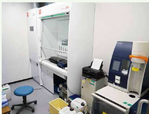
▲肥料分析：ドラフト（左）と窒素自動測定機（右）
